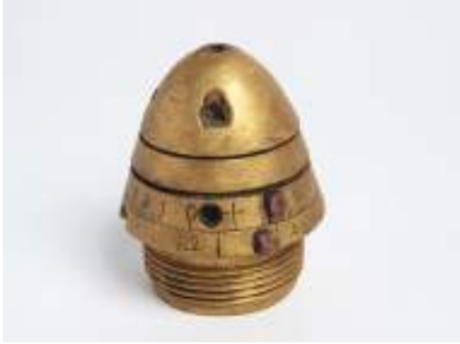
Figura 54. Fotografía de la espoleta de doble efecto, Mod. 1898 de Ángel Sanz Andrés para el libro ¡No solo cañones!
